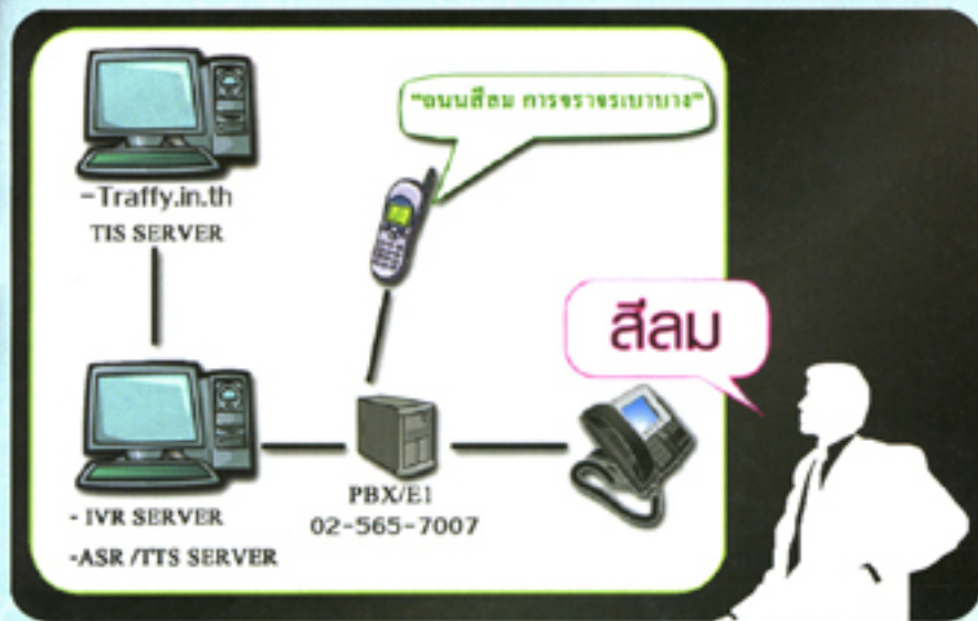
รูปที่ 1 ระบบตอบรับอัตโนมัติสำหรับการรายงานสภาพจราจร (TVIS)
